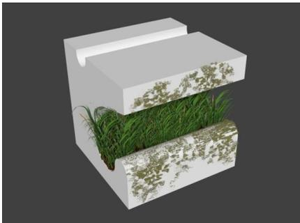
Abbildung 11: Bauelement zur vertikalen Begrünung (Quelle: FRAUNHOFER UMSICHT o.J.)
