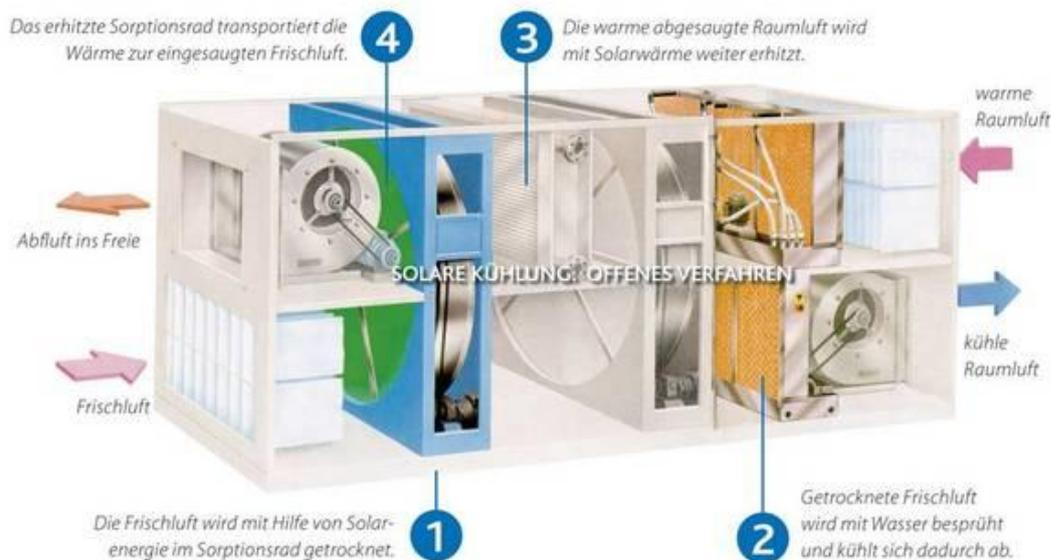
Abbildung 22: Solare Raumkühlung mittels dem Kaltluftverfahren (Quelle: INSTALLATIONSPROFI GMBH o. J.)
